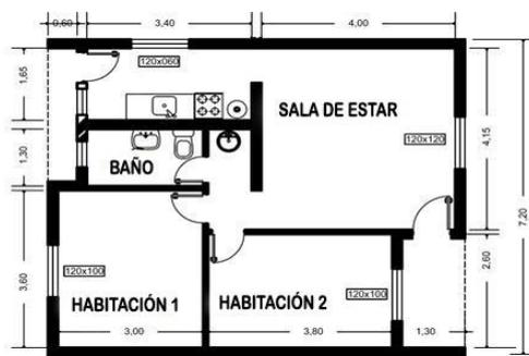
Fig. 2. Planta de la vivienda estudiada, de 50,74 m<sup>2</sup> de superficie (Instituto Provincial de la Vivienda de Salta). Muros de ladrillón hueco (18 m de espesor) y techos de chapa con 76,2 mm de lana de vidrio como aislante térmico.
